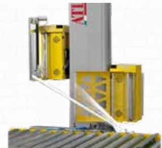
Le système de roping est une innovation qui permet d'obtenir une stabilisation supplémentaire de votre charge sur la palette, grâce à la création d'un cordon de film qui fixe solidement la partie supérieure de la palette à la charge.
